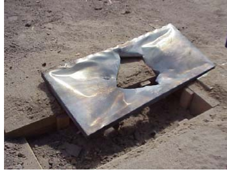
(d) the damaged witness plate in the experiment
